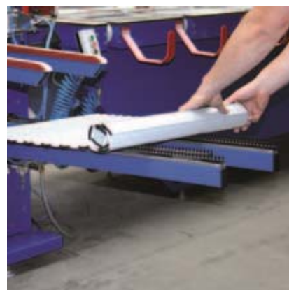
La surface des tabliers en aluminium est particulièrement sensible aux rayures. Il est recommandé de les enrouler manuellement
