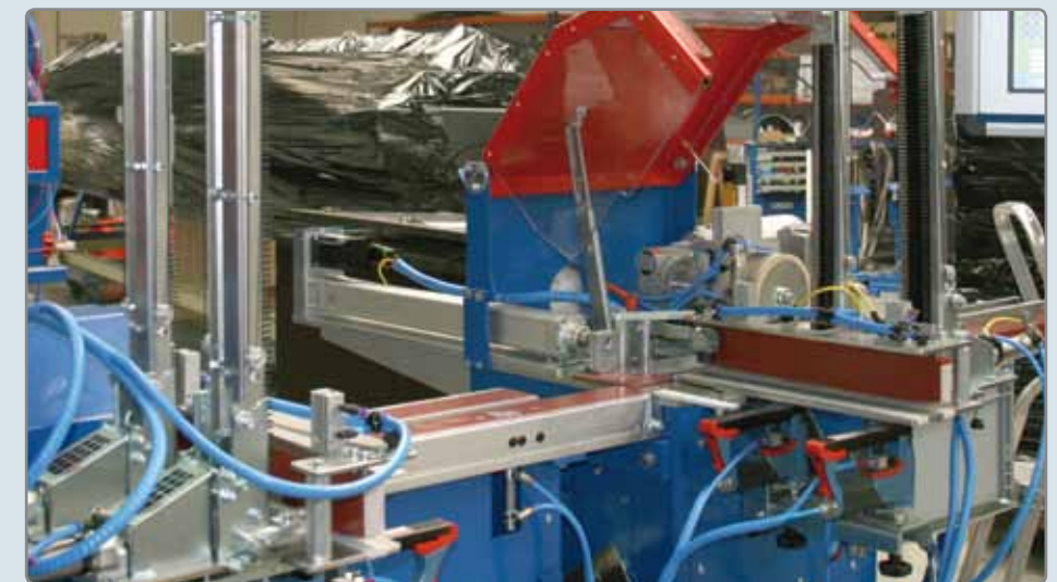
Efficace: 4 têtes d'agrafage et 4 chargeurs d'embouts pour l'usinage de deux profilés différents sans avoir à changer les têtes d'agrafage.
