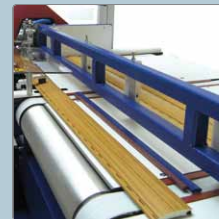
Gain de temps grâce à l'introduction automatique des lames.
