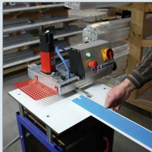
La fraise à sangles KS : pour la réalisation des rainures de sangles avec grande précision et sans bavure.
