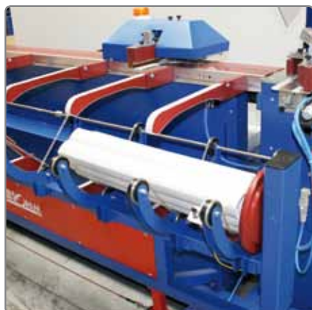
Enrouleur à commande motorisée pour l'enroulement du tablier.
