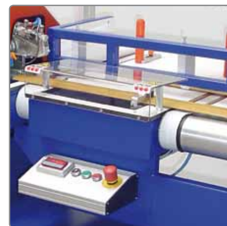
Affichage digital pour le contrôle de la largeur du volet roulant.
