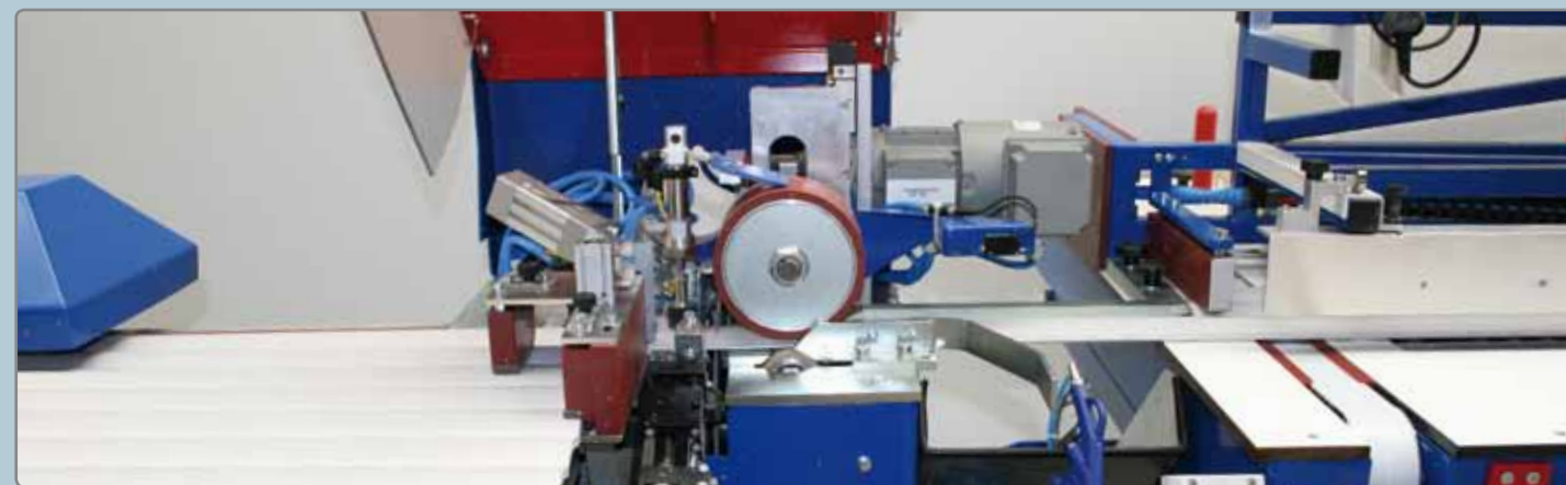
Roue d'entraînement avec revêtement PU pour le transport des lames en préservant le matériel.
