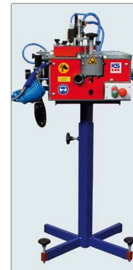
KS Alu Junior avec pied, réglable individuellement à la hauteur de travail de l'opérateur.
