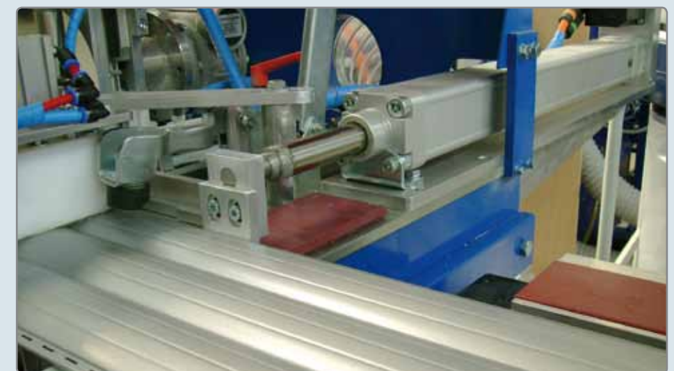
Vérins électrique et commande synchro assurant la rapidité et la précision de la poussée transversale des profilés et de l'agrafage des embouts.
