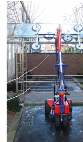
Un bras télescopique particulièrement long permet la mise en œuvre à de grandes hauteurs
