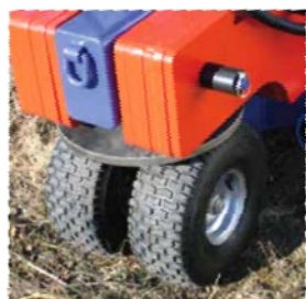
Deux grands pneus doubles évitent l'embourbement sur sols mouillés
